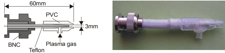
Fig. 7 Schema și imaginea torței de plasmă.
