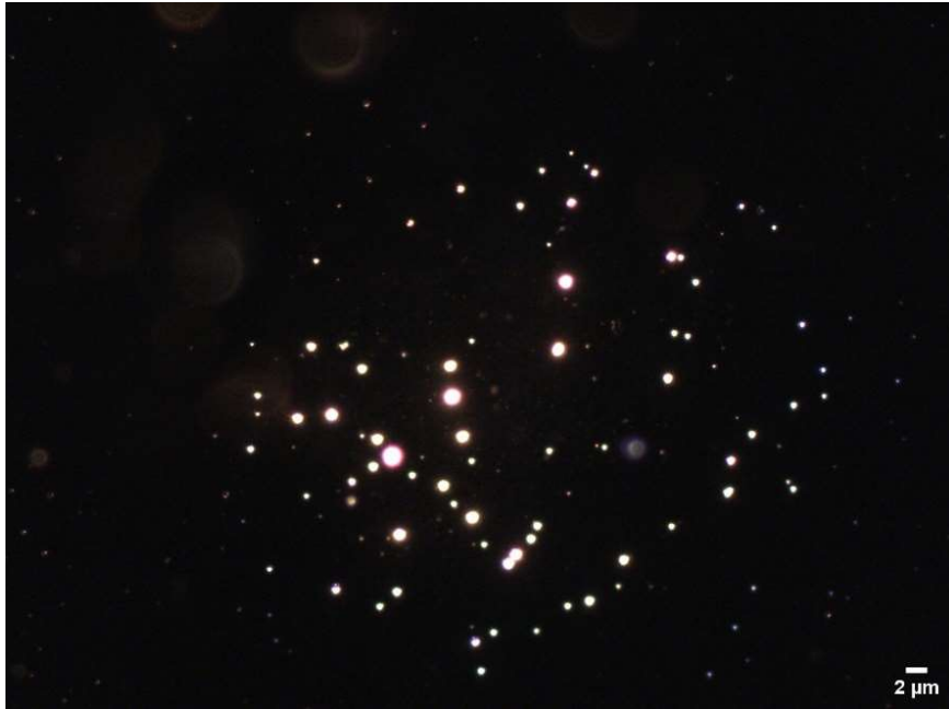
Figura 3.1 Exemplu de imagine optică a mierii de salcâm lot H1, obținută cu microscopul în câmp întunecat. Timp de expunere 100 ms, obiectiv 10x, apertură numerică 0.25.
