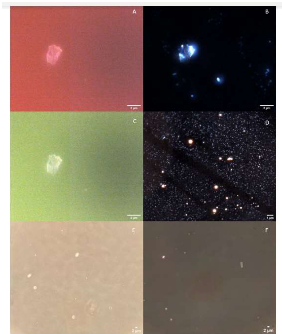
Figura 5.3 Imaginile achiziționate optic din lotul de miere H3 (A) autofluorescență, filtru 3, (B) autofluorescență fără filtru, (C) autofluorescență filtru 2, (D) câmp întunecat, (E) contrast de fază, (F) contrast de fază cu filtru polarizator
