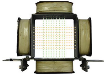
Figura 2.5. Bobinele de focusare și distribuția liniilor de câmp magnetic produs de acestea. [29]
