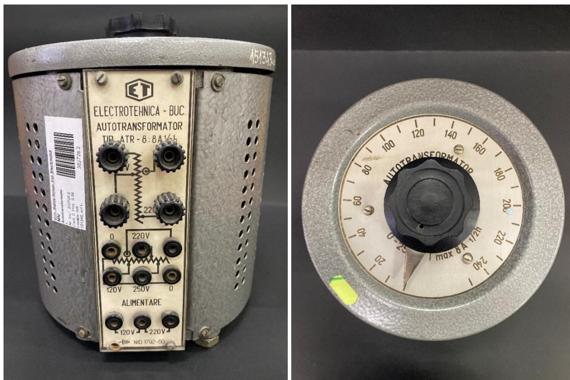
4. ábra – A takaréktanszformátor előlapja és látkepe felülnézetből
