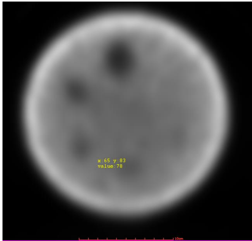
Figura 2.18 Intensitatea sferei de 19.1 mm diametru, obținute cu protocolul ACR
