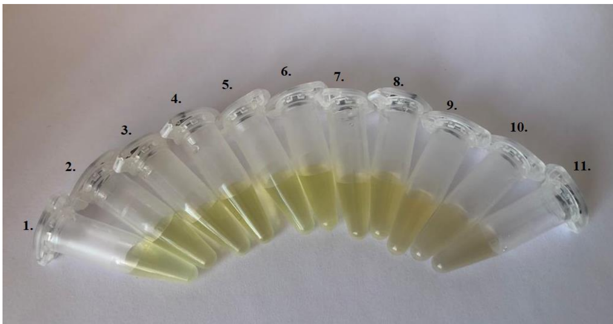
Fig. III. 4.2. Imagine digitală cu probele din laborator cu AgNPs+aptamer +CRP+NaCl.
