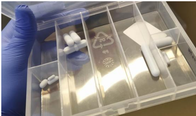
Figura 3.13. Magneții utilizați la uniformizarea depunerii NP
