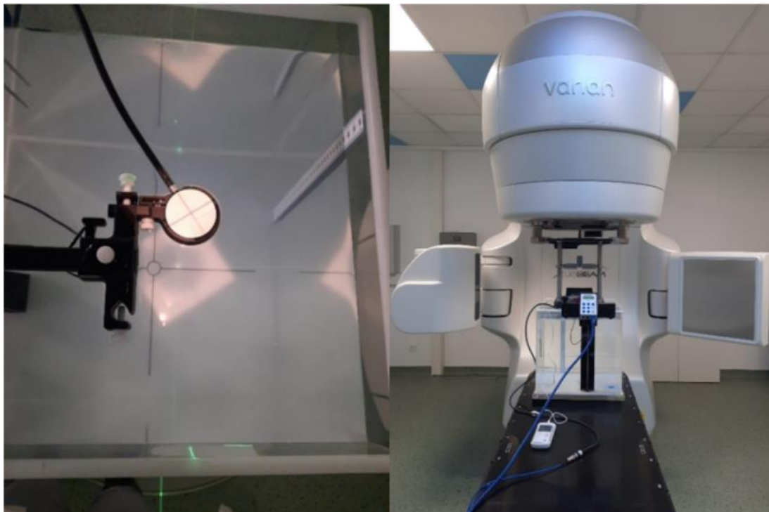
Figura 2.13 Camera de ionizare SNC350p poziționată, respectiv aplicatorul de 15 cm x 15 cm pus.
