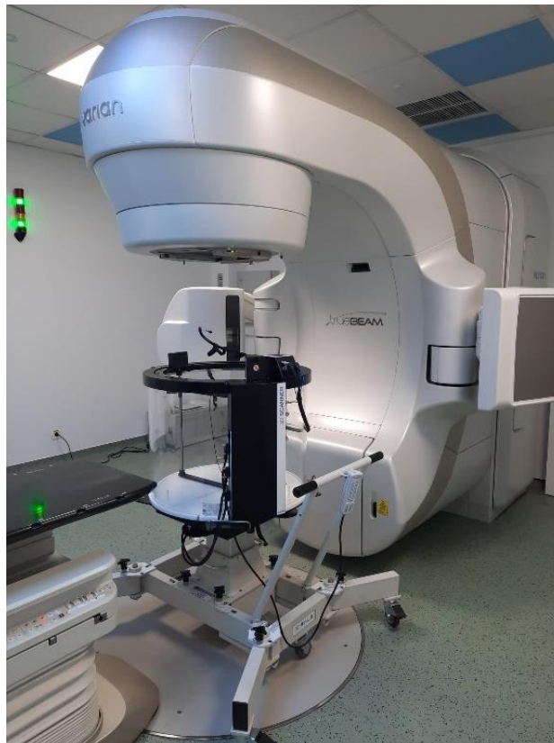
Figura 2.17 Poziționarea fantomei 3D Scanner de la Sun Nuclear.
