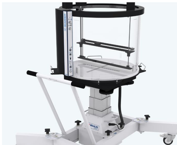
Figura 2.15 Fantoma de apă 3D Scanner de la Sun Nuclear.
