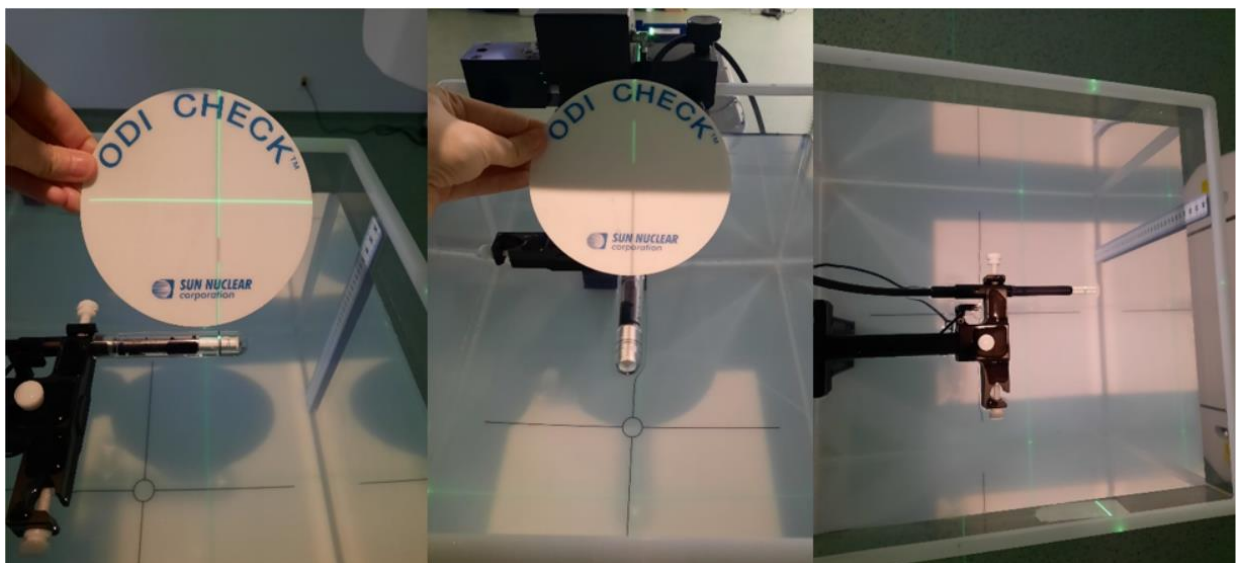
Figura 2.11 Camera de ionizare SNC600c poziționată în 1D Scanner pentru dozimetria absolută.
