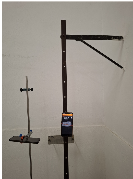
6.9. ábra. Kísérleti elrendezés gravitációs gyorsulás mérésére fizikai inga segítségével, Doppler-hatáson keresztül
