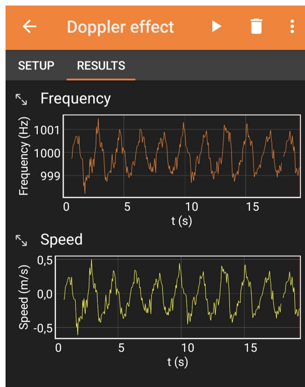
6.10. ábra. Doppler-hatás segítségével a fizikai inga periodikus mozgásának ábrázolása, amikor a tömegközéppont 60 cm távolságra van a felfüggesztési ponttól (frekvencia és sebesség az idő függvényében)
