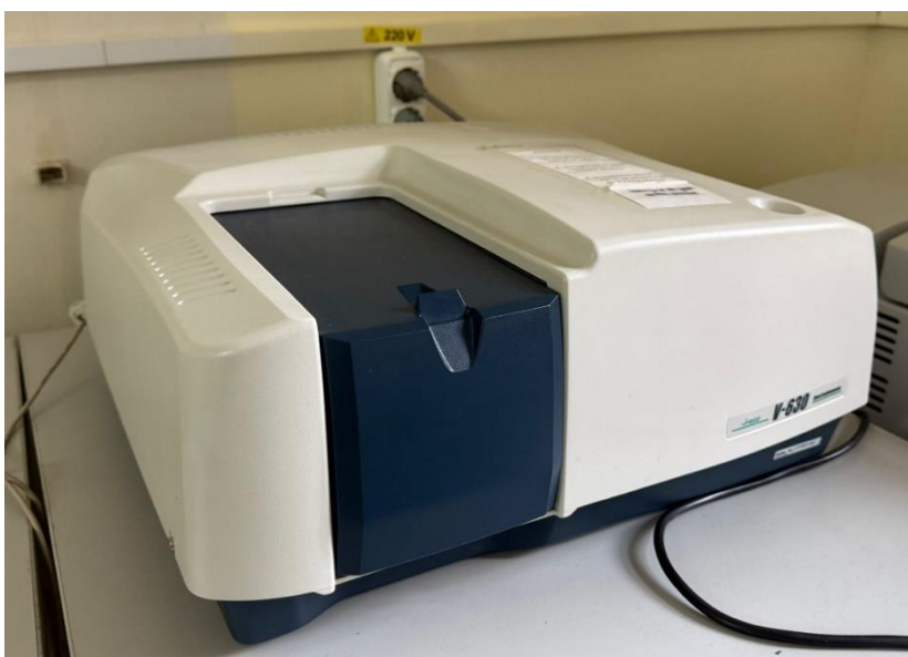
Figura 2.4 – Spectrometrul Jasco V-630, utilizat pentru achiziționarea spectrelor de absorbție UV-Vis.
