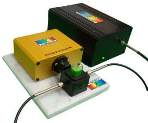
Figura A1.1 Aparatura folosită pentru înregistrarea spectrelor de fluorescență clasică. Spectrometrul de fluorescență StellarNet Inc.[42]
