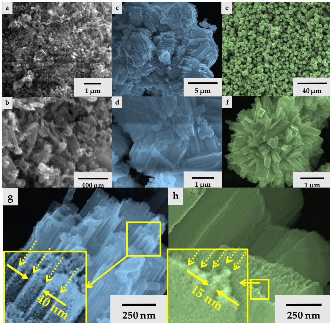
*Fotodepunere selectiva de particule de metal nobil pe semiconductori de  $TiO_2$  si  $WO_3$  (stanga) si evaluarea compositelor prin DRS (dreapta)*
