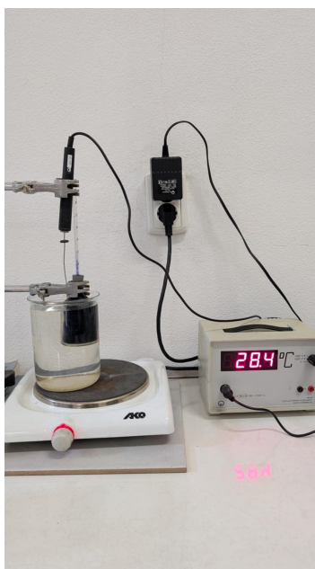
1. ábra. A mérési berendezés (dilatométer): színes vízzel töltött lombik, vízzel telt edény, elektromos hőmérő és melegítő.
