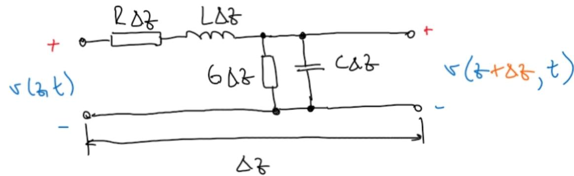
$R [\Omega/m]$   $\rightarrow$  conductivitate finită a conductorilor
