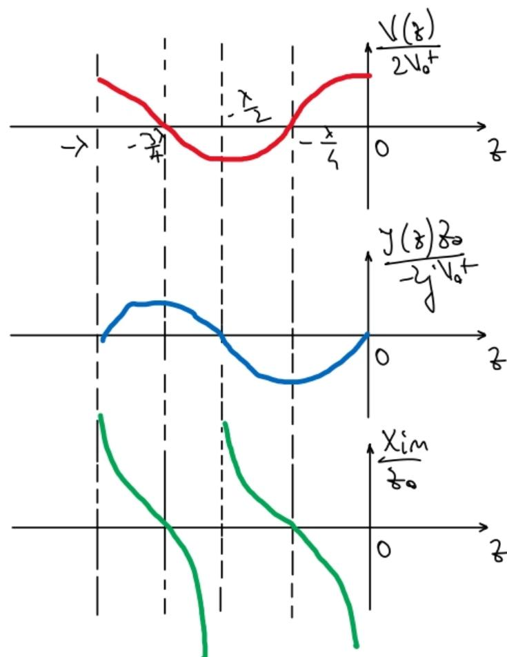
Liniu cu lungimi speciale: (liniu terminate în  $z_0$ )
